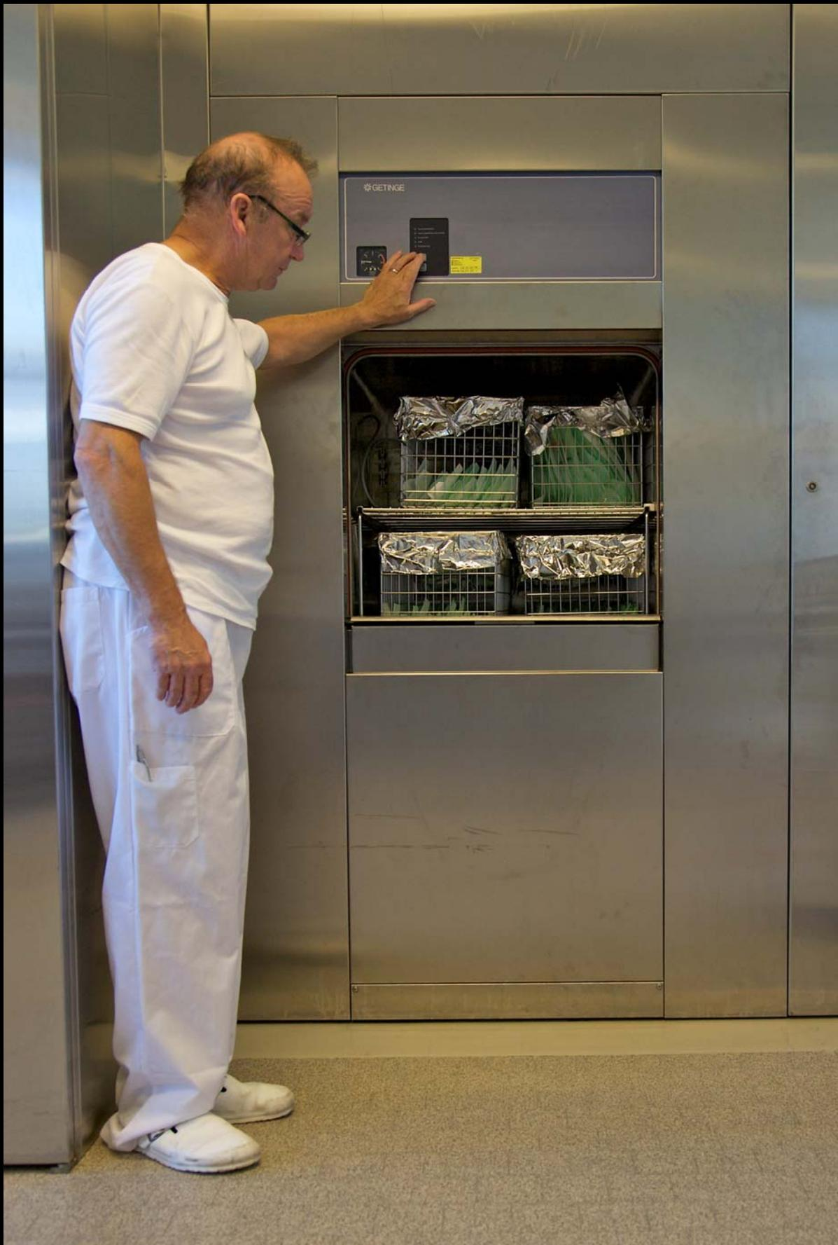
Endsterilisation im Autoklaven bei einer Stabilphase von mindestens 121°C für 20 Minuten ohne Vakuum.
