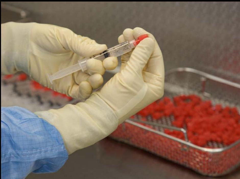
Abfüllung des Lokalanästhesie-Gels und Verschliessen der Spritzen mit einem Kombi-Stopper unter aseptischen Bedingungen.
