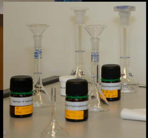
Prüfung nach Ph.Eur. auf Identität und Gehalt der Inhaltsstoffe sowie auf Zersetzungsprodukte mittels HPLC (High Pressure Liquid Chromatography). Diese Methode erlaubt die Auftrennung von Substanzgemischen. Die Einzelsubstanzen dienen als Referenz.
