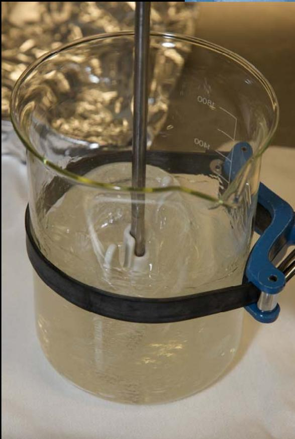
Die Inhaltsstoffe werden mit Hilfe des IKS Rührwerks gemischt, ca. 700 Umdrehungen pro Minute während mindestens 90 min.
