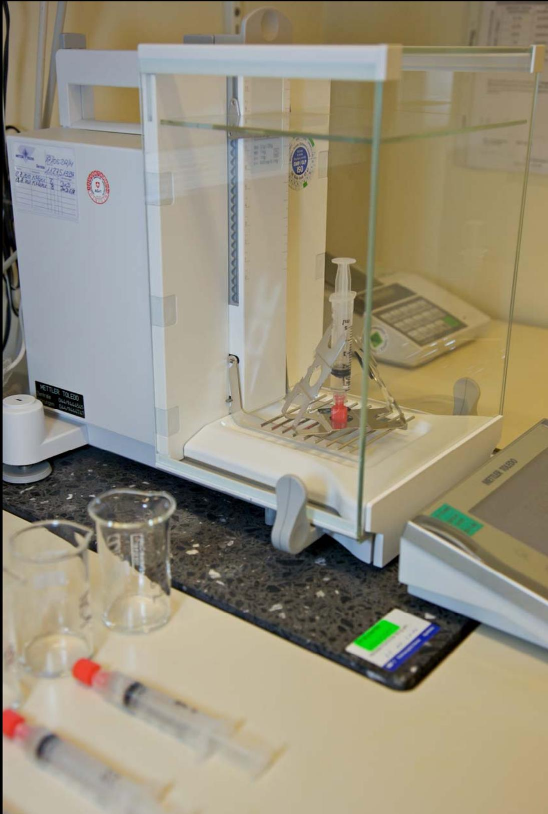
Differenzwägung der Spritzen vor und nach der Entnahme von Wundgel zur Gehaltsbestimmung der Wirkstoffe Lidocain und Tetracain im Rahmen der Qualitätskontrolle.
